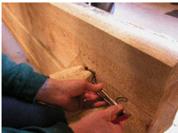
Med spetspassaren markeras hur mycket som skall justeras och med passaren ritas linjer för justeringar i 6st halsningar
