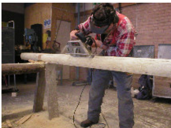
Stocken lyfts bort och långdraget sågas ut. Knuten skalas av i underkant
